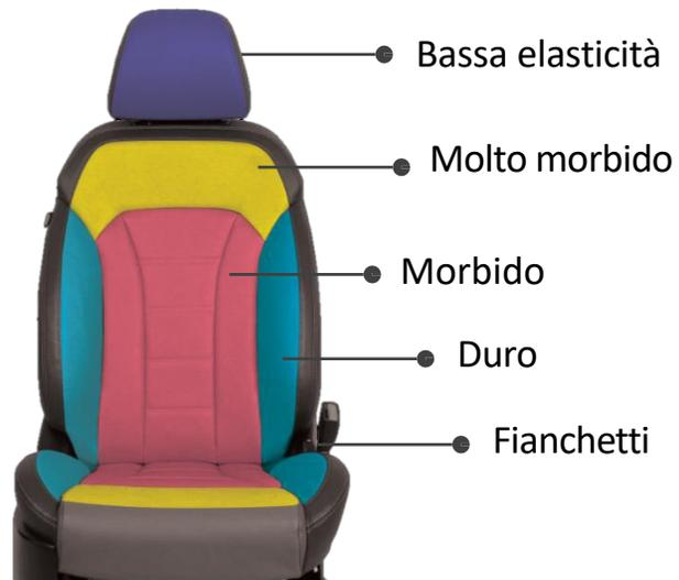
I sedili ergonomici sono stati concepiti per adattarsi alla corporatura dei passeggeri, così da massimizzare il comfort in ogni condizione di viaggio grazie alla tecnologia **Fullmaflex** che deforma in maniera differenziata le schiume del sedile in funzione della posizione di seduta.
